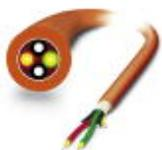
Cable de instalación PCF confeccionable robusto para interiores con elementos de aramida y compensadores de tensión con gran resistencia a rotura. Elementos individuales de material FRNC muy flexible. Sin halógenos, resistente al ozono y a los rayos ultravioleta con un revestimiento externo de poliuretano (PUR) robusto.
