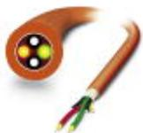
Cable de instalación PCF confeccionable robusto (solo cabezas IP 20) para la disposición en instalaciones y máquinas fijas, elementos de compensación de tracción de aramida, elementos individuales de material FRNC, sin halógenos, resistente al ozono y a los rayos ultravioleta, con un revestimiento externo de poliuretano (PUR)
