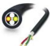
Cable redondo PCF confeccionable muy robusto (sólo cabezas IP 20) para disposición exterior con barrera de vapor integrada, así como una capa de hilo de vidrio anti roedores. Elementos individuales de material FRNC muy flexible. Resistente al ozono y a los rayos ultravioleta con un revestimiento externo de polietileno muy robusto.
