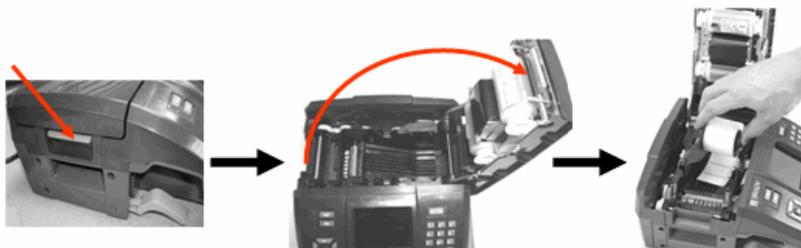
4. Introduisez l'extrémité des étiquettes jusqu'à la ligne noire sous les guides.
