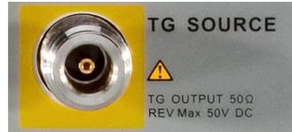
Per evitare danni al generatore di tracciamento, la Tensione Inversa DC non deve superare i 50V.
