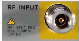
Per evitare danni allo strumento, assicurarsi che il segnale input presso la porta input RF non contenga più di 50 Volt DC. La componente di segnale input AC (Frequenza radio) non deve eccedere un livello di potenza continua massima di +30dBm.
