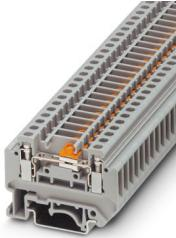
分断接线端子，标称工作电压: 400 V，额定电流: 26 A，接线方式: 螺钉连接，额定接线容量: 4 mm<sup>2</sup>，接线容量: 0.2 mm<sup>2</sup> - 4 mm<sup>2</sup>，安装方式: NS 35/7,5，NS 35/15，NS 32，颜色: 灰色
