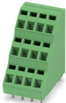
印制电路板终端，额定电流: 12 A，额定电压(III/2): 400 V，额定横截面: 1.5 mm<sup>2</sup>，电位数: 12，行数: 3，每行位数: 4，产品系列: ZFK3DS(A) 1,5，针距: 5.08 mm，接线方式: 回拉式弹簧连接，安装: 波峰焊，导线/PCB连接方向: 45°，颜色: 绿色，针脚排列: 直线排列，焊针[P]: 3.4 mm，每个电势的焊针数量: 1，包装类型: 纸箱包装
