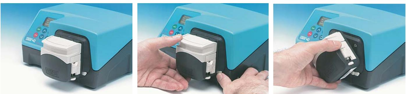
Verriegelungshebel nach hinten drücken und den Pumpenkopf so weit gegen den Uhrzeigersinn drehen, bis er von der Grundplatte abgenommen werden kann.
