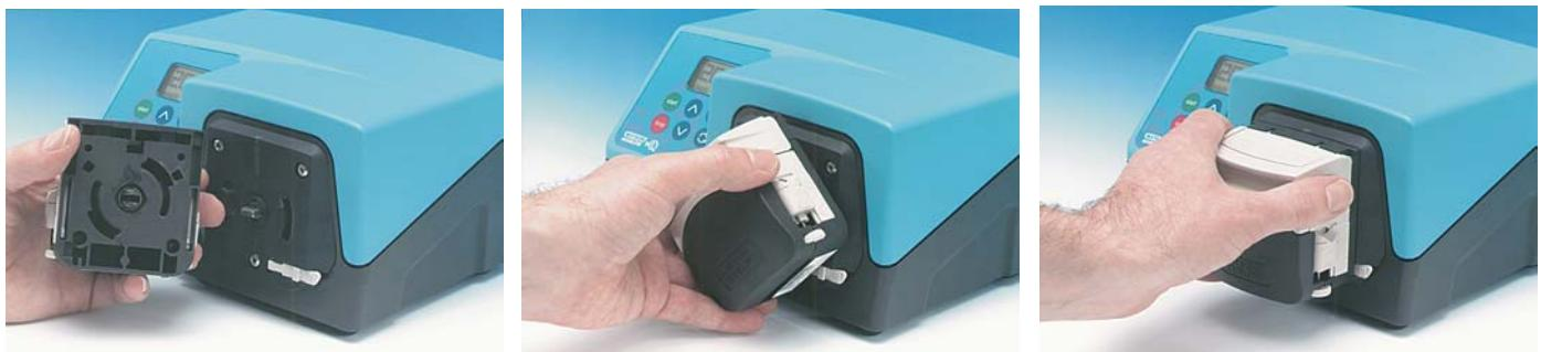
Die Antriebswelle der Pumpe in den Antriebsschlitz des Pumpenkopfs einführen. Den Pumpenkopf so ausrichten, dass die Bajonettkupplung in die Grundplatte greift. Pumpenkopf im Uhrzeigersinn bis zum Einrasten in senkrechter Stellung drehen.
