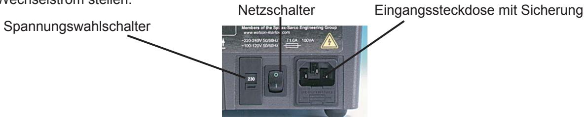
Das Netzkabel wird mit Netzkabel und Normstecker geliefert. Farbkennung des Netzkabels
