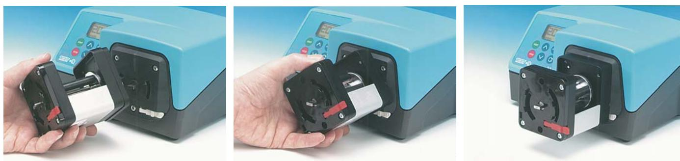
Die Antriebswelle der Pumpe in den Antriebsschlitz des Pumpenkopfs einführen. Den Pumpenkopf so ausrichten, dass die Bajonettkupplung in die Grundplatte greift. Pumpenkopf bis zum Einrasten in senkrechter Stellung drehen.
