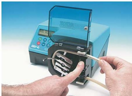
Schlauch um die Führungsbahn der Pumpe herum führen und das andere Schlauchende in die Schlauchklemme einlegen.
