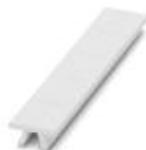
Repérage ZB, à commander : par bandes, blanc, impression selon les indications du client, type de montage: encliquetage dans la rainure de repérage élevée, pour bloc de jonction au pas de : 12,2 mm, surface utile: 10,5 x 12,15 mm
