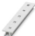
Repérage ZB, Rubans, blanc, repéré, impression longitudinale: L1, L2, L3, N, PE, type de montage: encliquetage dans la rainure de repérage élevée, pour bloc de jonction au pas de : 12,2 mm, surface utile: 10,5 x 12,15 mm
