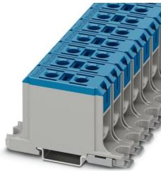
大电流接线端子，标称工作电压: 1000 V，额定电流: 145 A，连接量: 2，位数: 1，接线方式: 螺钉连接，额定接线容量: 50 mm<sup>2</sup>，横截面: 6 mm<sup>2</sup> - 50 mm<sup>2</sup>，额定接线容量: 50 mm<sup>2</sup>，横截面: 4 mm<sup>2</sup> - 50 mm<sup>2</sup>，安装方式: NS 35/15，NS 35/7,5，颜色: 蓝色
