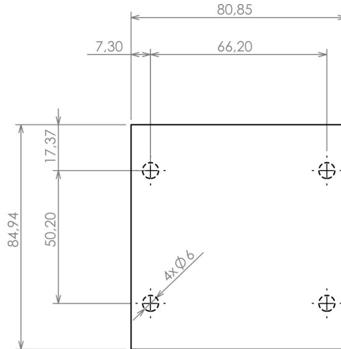
Die gestrichelte Linie zeigt den Umriss des Montagevorsprungs unter der Leiterplatte
