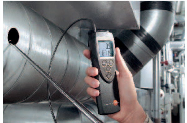
testo 425, z.B. zur Bestimmung des Volumestroms der Abluft
