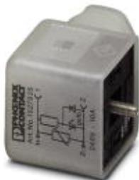
Connettore per valvole, 3-poli, Connettore per valvole A, con 1 LED, collegato con Varistore, Connessione a vite, connessione a vite per cavo Pg9, diametro esterno cavo 6 mm ... 8 mm
