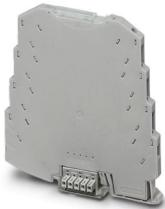
DIN导轨壳体，完整壳体，高型设计，带TBUS选项，采用螺钉连接，宽度: 6.3 mm，高度: 93.1 mm，深度: 101.2 mm，颜色: 浅灰(类似 RAL 7035)，交叉连接: DIN导轨总线连接器(可选)
