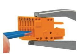
Raccordement du conducteur – manipulation de la connexion CAGE CLAMP® avec outil de manipulation (2,5 x 0,4) mm Perpendiculairement à l'axe du conducteur.
