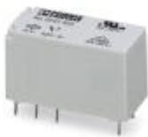
Relais de puissance miniature enfichable à contact doré multicouche, pour courants permanents élevés, 1 contact inverseur, tension d'entrée 24 V AC
