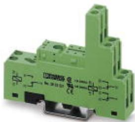
Support de relais PR1..., pour relais de puissance miniatures ou relais miniatures à 1 ou 2 contacts inverseurs ou relais statiques de forme similaire, version à 1/3 étages, connexions vissées, possibilité d'enfichage pour modules d'entrée/antiparasitage
