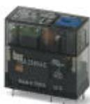
Relais miniature enfichable, avec contact multicouches plaqué or, 1 contact inverseur, touche de test, affichage mécanique de position, voyant d'état, diode de roue libre, polarité A1+, A2-, tension d'entrée 24 V DC
