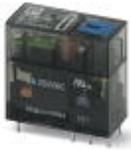
Relais miniature enfichable, avec contact multicouches plaqué or, 2 contacts inverseurs, touche de test, affichage mécanique de position, voyant d'état, diode de roue libre, polarité A1+, A2-, tension d'entrée 24 V DC
