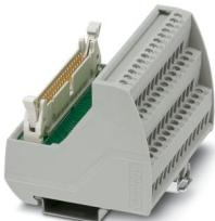
VARIOFACE-Modul, mit Schraubanschluss und Flachbandkabel-Steckverbinder, zur Montage auf NS 35-Tragschienen, mit Stiftleiste sowie kurzen und langen Verriegelungsbügeln für Buchsenleisten, Polzahl: 40
