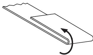
1) ストラップの片方の切り口を約13mm程度折り曲げます
