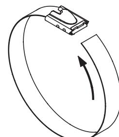
3) ロッキングヘッドの下でストラップが平らになるように折り曲げて組み立ての完成です
