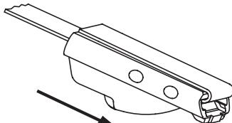
2) ロッキングヘッドを、反対側の切り口から挿入してストラップにそってバンドの折り目の部分までスライドさせます
