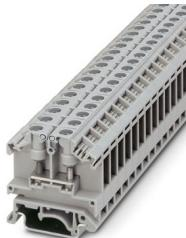
采用螺栓连接的通用端子，接线容量：0.1 -2.5 mm<sup>2</sup>，厚度：9 mm，颜色：灰色
