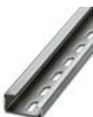
Carril simétrico perforado, Perfil G, anchura: 32 mm, altura: 15 mm, según EN 60715, material: Acero, galvanizado, pasivado de capa gruesa, longitud: 2000 mm, color: plata
