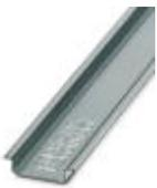
Carril simétrico sin perforar, Perfil estándar, anchura: 35 mm, altura: 7,5 mm, según EN 60715, material: Acero, Galvanizado, pasivado blanco, longitud: 2000 mm, color: plateado
