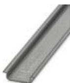
Guida di supporto, non perforata, Profilo standard, larghezza: 35 mm, altezza: 7,5 mm, a norma EN 60715, materiale: acciaio inox V2A, non rivestito, lunghezza: 2000 mm, colore: color argento
