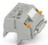
Adattatore V8 per 8 x PLC-INTERFACE (6,2 mm), controllore: Cablaggio di sistema PLC delle schede d'ingresso, collegamento 1: Connessione a vite 1x, collegamento 2: Connettore femmina D-SUB 1x 15-poli, collegamento 3: Attacco connettore (Può essere agganciato a scatto su 8 morsetti PLC-INTERFACE), numero di canali: 8, logica di comando: commutazione positiva
