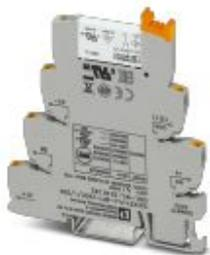
PLC-INTERFACE per funzioni di input, composta da morsetto base PLC-BPT.../SEN con connessione Push-in e relè in miniatura a innesto con contatto in oro multistrato, per il montaggio su guida di montaggio NS 35/7,5, 1 contatto aperto a riposo, tens. di ingresso 24 V DC
