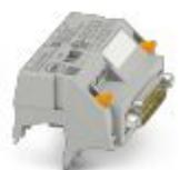
Adattatore V8 per 8 x PLC-INTERFACE (6,2 mm), controllore: Cablaggio di sistema PLC delle schede d'ingresso, collegamento 1: Connessione a vite 1x, collegamento 2: Connettore maschio D-SUB 1x 15-poli, collegamento 3: Attacco connettore (Può essere agganciato a scatto su 8 morsetti PLC-INTERFACE), numero di canali: 8, logica di comando: commutazione positiva
