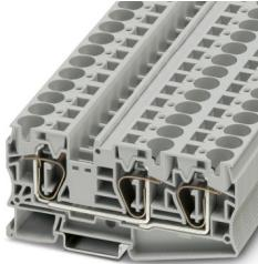
直通式接线端子，标称工作电压: 1000 V，额定电流: 76 A，连接量: 3，接线方式: 回拉式弹簧连接，额定接线容量: 16 mm<sup>2</sup>，横截面: 0.2 mm<sup>2</sup> - 25 mm<sup>2</sup>，安装方式: NS 35/15，NS 35/7.5，颜色: 灰色
