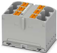
接线板，底座端子，标称工作电压: 450 V，额定电流: 57 A，连接量: 6，接线方式: 直插式连接，额定接线容量: 10 mm<sup>2</sup>，横截面: 0.5 mm<sup>2</sup> - 16 mm<sup>2</sup>，安装方式: 用于卡接在DIN导轨适配器上，直接安装，带法兰，自由悬挂，颜色: 灰色
