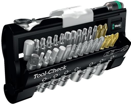
28 puntas, 7 vasos mecánico-manuales, 1 porta-puntas Rapidaptor, 1 pieza de conexión 870/1 (de hexagonal de 1/4" a cuadrado de 1/4"). 1 carraca de puntas de Wera, versión de acero forjado mediante estampación; adecuado para puntas de arrastre de hexagonal exterior 1/4" según DIN 3126-C 6,3 y E 6,3 (ISO 1173) y series de conexión de Wera 1 y 4; por medio de la adaptación con el adaptador 870/1 también es posible utilizar vasos de 1/4".
