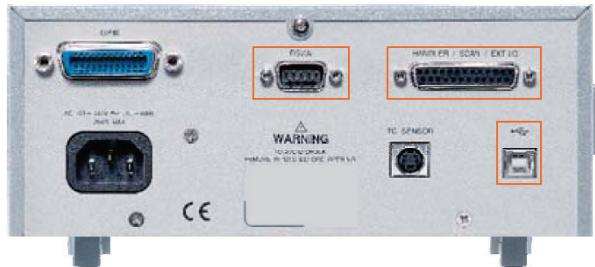
En ce qui concerne la connexion à la commande externe, le milliohmètre RM-804/805 fournit une interface composite Sub-D de 25 broches pour exécuter, suivant les fonctionnalités Handler, Scan ou EXT IO pour la connexion à une machine de tri, à un commutateur de marche-arrêt externe et à une commande de déclenchement externe directe respectivement. Pour les exigences de
