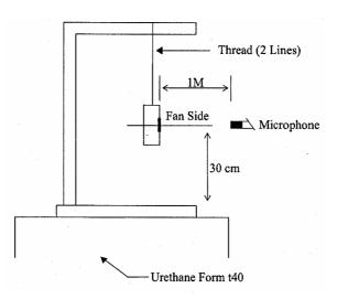
1 METER FROM MICROPHONE TO FAN INTAKE
