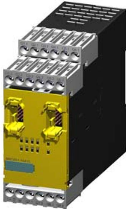
SIRIUS, Erweiterungsmodul 3RK32 für modulares Sicherheitssystem 3RK3 4/8 F-RO, DC 24 V/1 A parametrierbar über MSS ES 45 mm Baubreite Schraubanschluss bis SIL3 (IEC 61508) bis Performance Level E (ISO 13849-1) ohne Verbindungskabel
