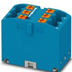
接线板，底座端子，标称工作电压: 450 V，额定电流: 24 A，连接量: 6，接线方式: 直插式连接，横截面: 0.14 mm<sup>2</sup> - 4 mm<sup>2</sup>，安装方式: 用于卡接在DIN导轨适配器上，直接安装，带法兰，自由悬挂，颜色: 蓝色
