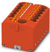
接线板，底座端子及电源，标称工作电压: 450 V，额定电流: 24 A，连接量: 13，接线方式: 直插式连接，负载触点，横截面: 0.14 mm<sup>2</sup> - 4 mm<sup>2</sup>，直插式连接，线路触点，额定接线容量: 6 mm<sup>2</sup>，横截面: 0.5 mm<sup>2</sup> - 10 mm<sup>2</sup>，安装方式: 用于卡接在DIN导轨适配器上，直接安装，带法兰，自由悬挂，颜色: 红色
