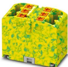
接线板，基座端子没有保护导线功能，标称工作电压: 450 V，额定电流: 24 A，连接量: 6，接线方式: 直插式连接，横截面: 0.14 mm<sup>2</sup> - 4 mm<sup>2</sup>，安装方式: 自由悬挂，颜色: 绿色/黄色
