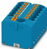
接线板，底座端子及电源，标称工作电压: 450 V，额定电流: 24 A，连接量: 13，接线方式: 直插式连接，负载触点，横截面: 0.14 mm<sup>2</sup> - 4 mm<sup>2</sup>，直插式连接，线路触点，额定接线容量: 6 mm<sup>2</sup>，横截面: 0.5 mm<sup>2</sup> - 10 mm<sup>2</sup>，安装方式: 用于卡接在DIN导轨适配器上，直接安装，带法兰，自由悬挂，颜色: 蓝色
