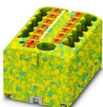
接线板，带嵌入的基座端子没有保护导线功能，标称工作电压: 450 V，额定电流: 24 A，连接量: 13，接线方式: 直插式连接，负载触点，横截面: 0.14 mm<sup>2</sup> - 4 mm<sup>2</sup>，直插式连接，线路触点，额定接线容量: 6 mm<sup>2</sup>，横截面: 0.5 mm<sup>2</sup> - 10 mm<sup>2</sup>，安装方式: 自由悬挂，颜色: 绿色/黄色
