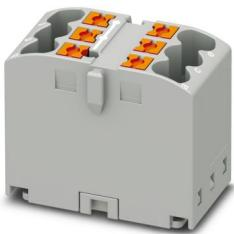
接线板，底座端子，标称工作电压: 450 V，额定电流: 24 A，连接量: 6，接线方式: 直插式连接，横截面: 0.14 mm<sup>2</sup> - 4 mm<sup>2</sup>，安装方式: 用于卡接在DIN导轨适配器上，直接安装，带法兰，自由悬挂，颜色: 灰色
