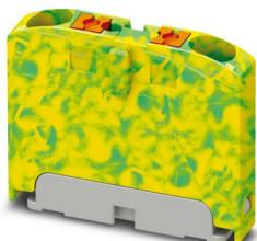
单模块，基座端子没有保护导线功能，标称工作电压: 450 V，额定电流: 24 A，连接量: 2，接线方式: 直插式连接，横截面: 0.14 mm<sup>2</sup> - 4 mm<sup>2</sup>，安装方式: 自由悬挂，颜色: 绿色/黄色
