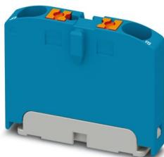
单模块，底座端子，标称工作电压: 450 V，额定电流: 24 A，连接量: 2，接线方式: 直插式连接，横截面: 0.14 mm<sup>2</sup> - 4 mm<sup>2</sup>，安装方式: 用于卡接在DIN导轨适配器上，直接安装，带法兰，自由悬挂，颜色: 蓝色
