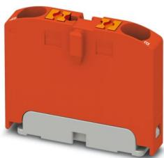
单模块，底座端子，标称工作电压: 450 V，额定电流: 24 A，连接量: 2，接线方式: 直插式连接，横截面: 0.14 mm<sup>2</sup> - 4 mm<sup>2</sup>，安装方式: 用于卡接在DIN导轨适配器上，直接安装，带法兰，自由悬挂，颜色: 红色
