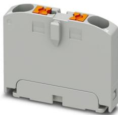
单模块，底座端子，标称工作电压: 450 V，额定电流: 24 A，连接量: 2，接线方式: 直插式连接，横截面: 0.14 mm<sup>2</sup> - 4 mm<sup>2</sup>，安装方式: 用于卡接在DIN导轨适配器上，直接安装，带法兰，自由悬挂，颜色: 灰色
