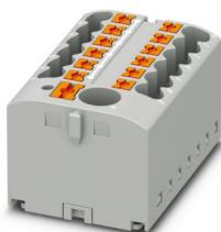
接线板，底座端子及电源，标称工作电压: 450 V，额定电流: 24 A，连接量: 13，接线方式: 直插式连接，负载触点，横截面: 0.14 mm<sup>2</sup> - 4 mm<sup>2</sup>，直插式连接，线路触点，额定接线容量: 6 mm<sup>2</sup>，横截面: 0.5 mm<sup>2</sup> - 10 mm<sup>2</sup>，安装方式: 用于卡接在DIN导轨适配器上，直接安装，带法兰，自由悬挂，颜色: 灰色
