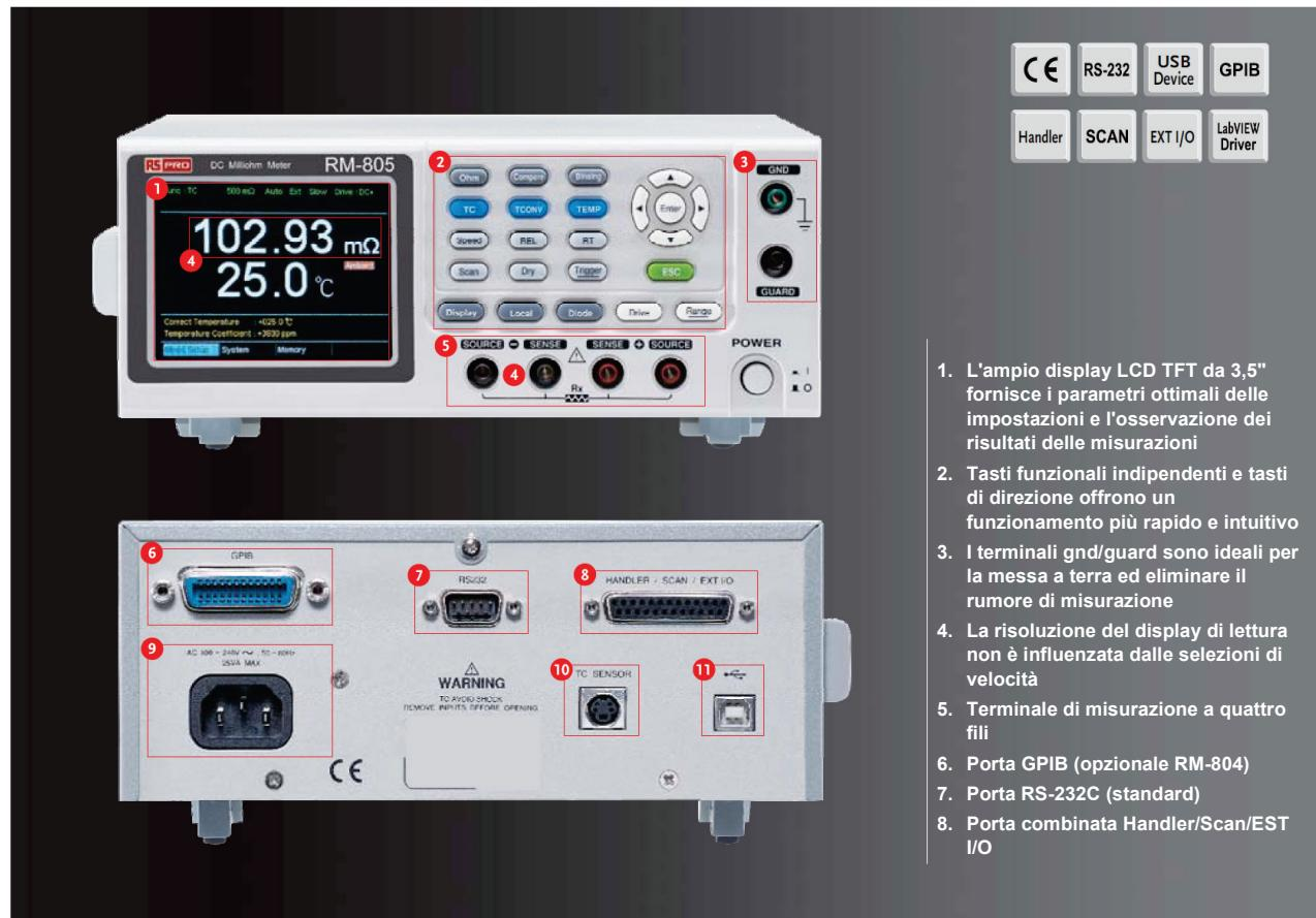
1. L'ampio display LCD TFT da 3,5" fornisce i parametri ottimali delle impostazioni e l'osservazione dei risultati delle misurazioni
