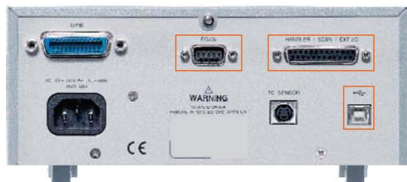
Per quanto riguarda il collegamento del comando esterno, RM-804/805 prevede un'interfaccia composita a 25 pin D-sub per eseguire, in base alle funzionalità, Handler, Scan o EST IO; per il collegamento a una macchina smistatrice, il collegamento a un interruttore esterno di accensione e spegnimento e la conduzione diretta del comando esterno di attivazione. Per il controllo remoto e i
