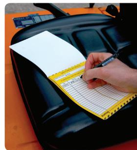
Avant d'utiliser le véhicule, enregistrez l'inspection sur l'insert Forkliftag® avec le numéro de référence du chariot élévateur à fourche.
