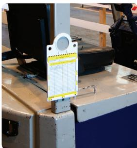
Si l'inspection du chariot élévateur est satisfaisante, l'insert est placé dans le support, avec la face jaune vers l'extérieur, indiquant que le chariot élévateur peut être utilisé en toute sécurité, de sorte que chacun puisse voir immédiatement quand a eu lieu la dernière inspection du véhicule.
