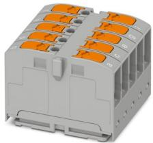
设备接线端子，标称工作电压: 450 V，额定电流: 24 A，连接量: 10，位数: 5，接线方式: 直插式连接，横截面: 0.14 mm<sup>2</sup> - 4 mm<sup>2</sup>，直插式连接，额定接线容量: 2.5 mm<sup>2</sup>，安装方式: 用于卡接在DIN导轨适配器上，直接安装，带法兰，自由悬挂，颜色: 灰色
