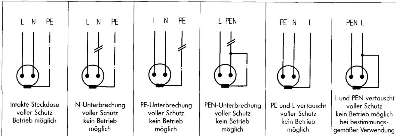
Der PRCD-S erkennt die Fremdspannung auf dem Schutzleiter – unterbricht jedoch die Schutzleiter-Verbindung nicht. Die Fremdspannung kann sich dadurch über ihre eigenen, vorgeschalteten Schutzorgane FI und LS freischalten.
