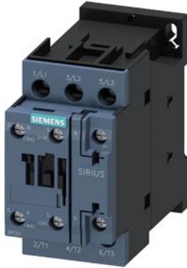
Leistungsschütz, AC-3e/AC-3, 9 A, 4 kW / 400 V, 3-polig, AC 230 V, 50/60 Hz,
