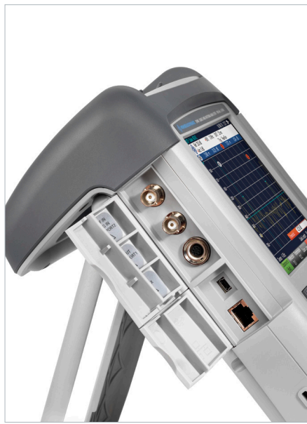
Zusätzliche Anschlüsse, z.B. für SD-Speicherkarte und USB-Schnittstelle, sind unter Abdeckkappen geschützt
