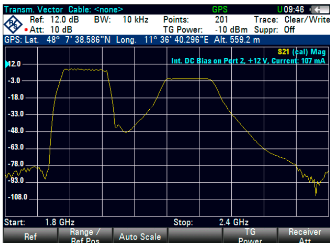
TMA-Transmissionsmessung: integrierte Spannungsversorgung, Strommessung mit angeschlossenem GPS-Empfänger R&S®HA-Z240
