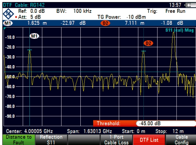
Kabelfehlstellenmessung (Distance-to-Fault, DTF)
