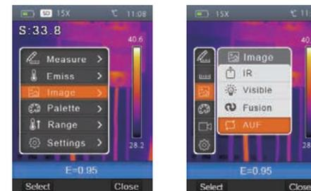
caméra thermique dispose de 4 types de modes d'image pour l'affichage. IR, Visible, IR\_Mix\_VIS, mode AUF.
