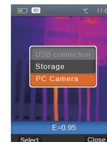
Il existe deux modes pour USB, stockage et caméra PC. Appuyez sur le bouton Haut ou Bas pour changer de mode.
