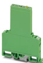
Eingabe-Solid-State-Relais, mit Leuchtanzeige und Schutzbeschaltung im Ein- und Ausgangskreis, Eingang: 230 V AC, Ausgang: 4 - 48 V DC/max. 100 mA
