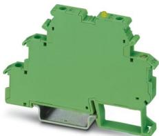
Leistungs-Solid-State-Relaisklemme für Aktor, Eingang: 24 V DC, Ausgang: 3-30 V DC/3 A, Klemmenbreite 6,2 mm
