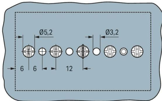
Dimensions en mm pour contact de terre et pied de fixation Ø 5,2 mm
