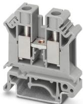
直通式接线端子，标称工作电压: 800 V，额定电流: 57 A，连接量: 2，接线方式: 螺钉连接，额定接线容量: 10 mm<sup>2</sup>，横截面: 0.5 mm<sup>2</sup> - 16 mm<sup>2</sup>，安装方式: NS 35/7,5，NS 35/15，NS 32，颜色: 灰色
