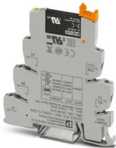
PLC-INTERFACE für Eingabefunktionen, bestehend aus Grundklemme PLC-BSC.../SEN mit Schraubanschluss und steckbarem Miniatur-Solid-State-Relais, zur Montage auf Tragschiene NS 35/7,5, 1 Schließer, Eingang: 120 V AC/110 V DC, Ausgang: 3-48 V DC/100 mA
