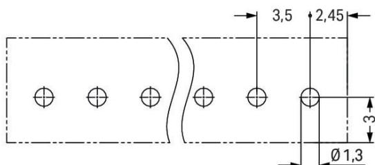
Connecteur mâle série 714 avec dimensions de la goupille de soudage 0,8 x 0,8 mm
