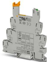
6,2 mm PLC-Grundklemme mit Schraubanschluss, ohne Relais- oder Solid-State-Relaisbestückung, zur Montage auf Tragschiene NS 35/7,5, 1 Wechsler, Eingangsspannung 24 V AC/DC
