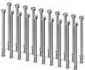
Tornillo de fijación opcional, sin moleteado para lugares que ofrecen poco espacio para el montaje, ranura, longitud: 40 mm, rosca UNC 4-40. Volumen de suministro: 1 bolsa con 20 tornillos
