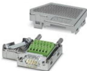
Conector D-SUB, 9 polos, macho, dos entradas de cables bajo 35°, sistema de bus: CAN, SUCONET K1, K2 (MOELLER), S-BUS (Saia), J-BUS (Merlin Gerin), ocupación de pins: 2, 3, 4, 5, 7, 9; en dos bornes de conexión por tornillo respectivamente
