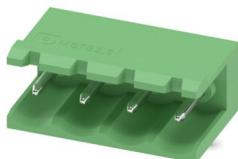
プリント基板用コネクタ・ソケット、定格接続サイズ: 2.5 mm<sup>2</sup>、色: 緑、定格電流: 12 A、定格電圧 ( III/2 ): 320 V、コンタクト表面: Sn、コンタクトタイプ: ピン、電位の数: 4、列の数: 1、極数: 4、接続数: 4、製品ラインアップ: MSTB 2,5/-G、ピッチ: 5.08 mm、取付け方法: ウエーブはんだ付け、ピン配列: 直線的なピン配置、はんだピン [P]: 3.23 mm、電位あたりのはんだピンの数: 1、プラグインシステム: COMBICON MSTB 2,5、はんだピン方向: 規格、嵌合ロック: なし、取付け方法: なし、梱包の種類: 段ボール梱包
