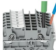
**Raccordement des conducteurs avec outil de manipulation.**Raccordement de conducteurs avec outil de manipulation
