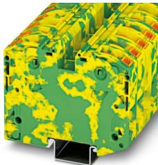
接地端子，连接量: 2，接线方式: PowerTurn连接，额定接线容量: 35 mm<sup>2</sup>，横截面: 2.5 mm<sup>2</sup> - 35 mm<sup>2</sup>，安装方式: NS 35/15，颜色: 黄绿相间
