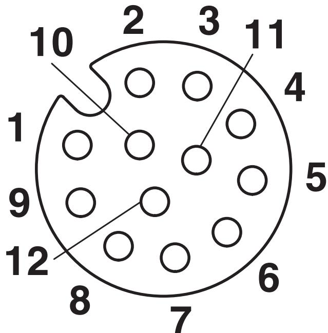
M12孔式连接器引脚分配 , 12芯 , A编码 , 插座侧视图
