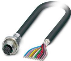
设备连接器 板后安装，通用，12-位置，PVC/PVC，黑色 RAL 9005，屏蔽，孔式，直头，M12-SPEEDCON，编码: A，与 端自由出线，板后安装，M16 x 1.5，电缆连接，电缆长度: 1 m，0.14 mm<sup>2</sup>，PVC黑色，备选产品符合RoHS II非豁免 6c (Pb < 0.1 %) 产品编号：1239765
