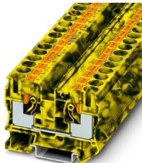
直通式接线端子，标称工作电压: 1000 V，额定电流: 57 A，连接量: 2，接线方式: 直插式连接，额定接线容量: 10 mm<sup>2</sup>，横截面: 0.5 mm<sup>2</sup> - 16 mm<sup>2</sup>，安装方式: NS 35/7,5，NS 35/15，颜色: 黑色/黄色
