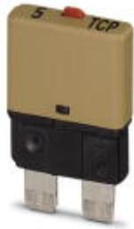
熱式機器用ミニチュアサーキットブレーカ、極数: 1、定格電流: 5 A、定格電圧: 32 V、幅: 6 mm、ヒューズタイプ: 低速遮断、ヒューズタイプ: 自動装置、取付けタイプ: ベースエレメント上、色: 薄茶
