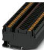
ヒューズ端子台、ヒューズタイプ: フラット、接続方式: プッシュイン式、断面積: 0.5 mm<sup>2</sup>- 10 mm<sup>2</sup>、AWG: 20 - 8、定格電流: 25 A、定格電圧: 12 V、幅: 8.2 mm、ヒューズタイプ: C、取付けタイプ: NS 35/7,5、NS 35/15、色: 黒
