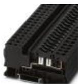
ヒューズ端子台、ヒューズタイプ: フラット、接続方式: スプリング接続式、断面積 : 0.08 mm<sup>2</sup>- 6 mm<sup>2</sup>、AWG: 28 - 10、定格電流: 30 A、定格電圧: 400 V、幅: 8.2 mm、ヒューズタイプ: C、取付けタイプ: NS 35/7,5、NS 35/15、色: 黒
