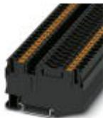
ヒューズ端子台、ヒューズタイプ: フラット、接続方式: プッシュイン式、断面積: 0.5 mm<sup>2</sup>- 10 mm<sup>2</sup>、AWG: 20 - 8、定格電流: 25 A、定格電圧: 400 V、幅: 8.2 mm、ヒューズタイプ: C、取付けタイプ: NS 35/7,5、NS 35/15、色: 黒
