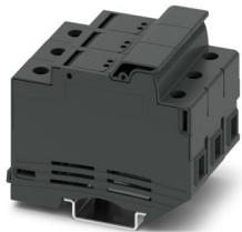
保险丝接线端子，保险丝类型: 玻璃 / 陶瓷 / ...，保险丝类型: CC型，标称工作电压: 600 V，额定电流: 30 A，接线方式: 螺钉连接，额定接线容量: 25 mm<sup>2</sup>，接线容量： 1.5 mm<sup>2</sup>- 25 mm<sup>2</sup>，安装方式: NS 35/7.5, NS 35/15, 颜色: 黑色
