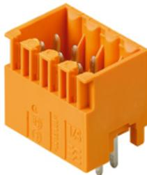
Connecteurs mâles double rangée, droits, en version avec extrémités latérales fermées ou avec brides (extrémités latérales fermées sur demande). Les connecteurs mâles avec longueur de picot de 3,5 mm sont conçus pour la soudure à la vague et conditionnés en boîte. Il est possible de les visser sur circuit imprimé. Les connecteurs mâles peuvent être codés et repérés.
