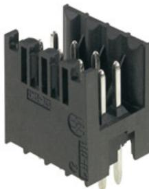
Connecteurs mâles double rangée droits, résistants aux hautes températures, pour tous process de soudure. Optimisés pour l'implantation automatique. Conditionnement en boîte ou en rouleau. Picots de 3,2 mm adaptés à la soudure à la vague et par refusion. Ils peuvent être codés et repérés. (conditionnement en bande sur demande)
