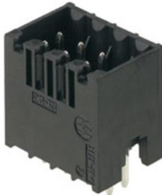
Connecteurs mâles double rangée droits, résistants aux hautes températures, pour tous process de soudure. Optimisés pour l'implantation automatique. Conditionnement en boîte ou en rouleau. Picots de 3,2 mm adaptés à la soudure à la vague et par refusion. Ils peuvent être codés et repérés.
