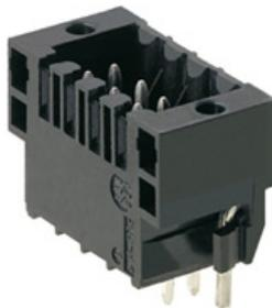
Connecteurs mâles double rangée droits, résistants aux hautes températures, pour tous process de soudure. Optimisés pour l'implantation automatique. Conditionnement en boîte ou en rouleau. Picots de 3,2 mm adaptés à la soudure à la vague et par refusion. Ils peuvent être codés et repérés.
