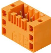
Connecteurs mâles double rangée, droits, en version avec extrémités latérales fermées ou avec brides (extrémités latérales fermées sur demande). Les connecteurs mâles avec longueur de picot de 3,5 mm sont conçus pour la soudure à la vague et conditionnés en boîte. Il est possible de les visser sur circuit imprimé. Les connecteurs mâles peuvent être codés et repérés.
