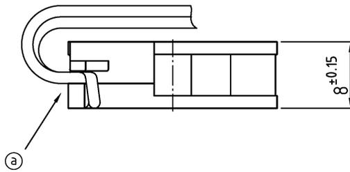
Tolerierung/Tolerances: DIN 7167
